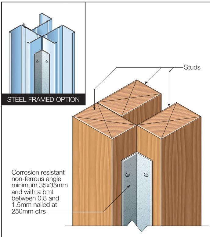
FIGURE 3 ANGLE REINFORCED CORNER - NON SHOWER AREA
