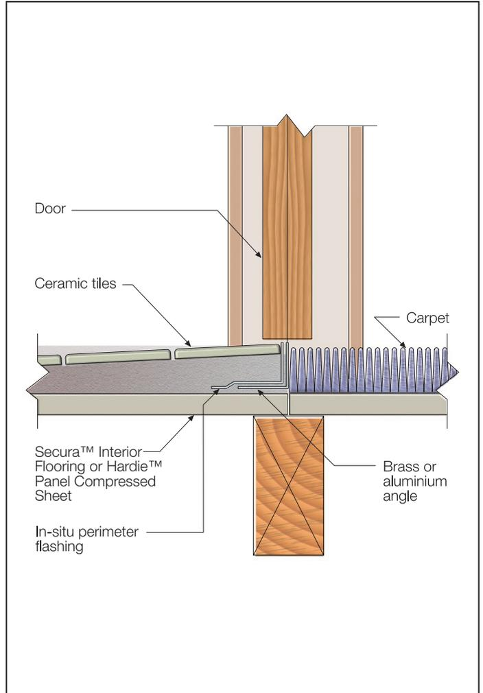
**FIGURE 8 DOORWAY FLASHING**
