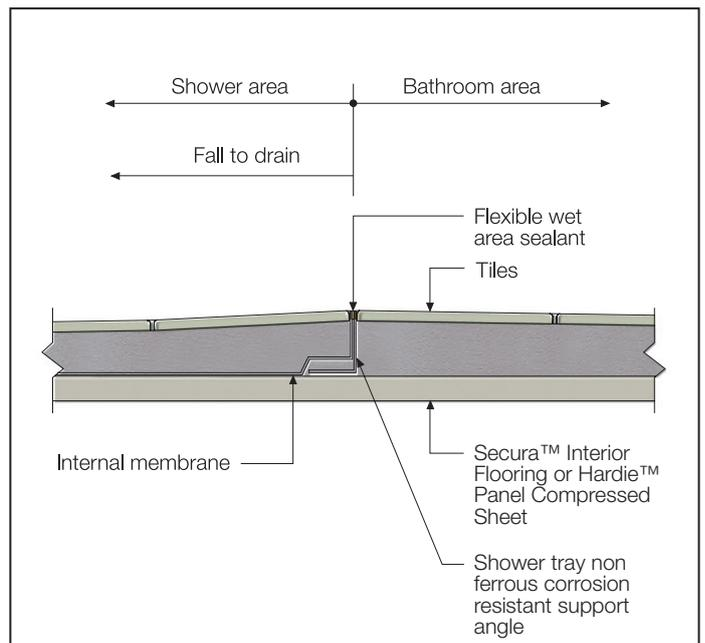
FIGURE 22 UNENCLOSED SHOWER - EDGE FINISHING DETAIL
