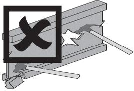
**DON'T HAMMER ON FLANGES AND DAMAGE JOINT**
