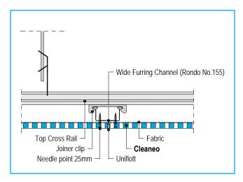
FIGURE 14 Short Edge Joint FF
